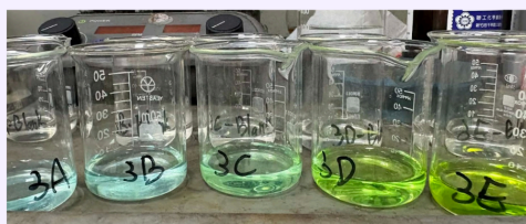
圖3 硫酸銅加入鹽酸梯度顏色情形
