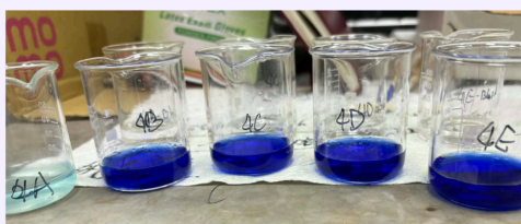
圖4 硫酸銅加入氨水梯度顏色情形
