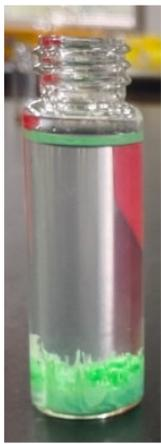
(圖五) 硝酸鎳晶體
